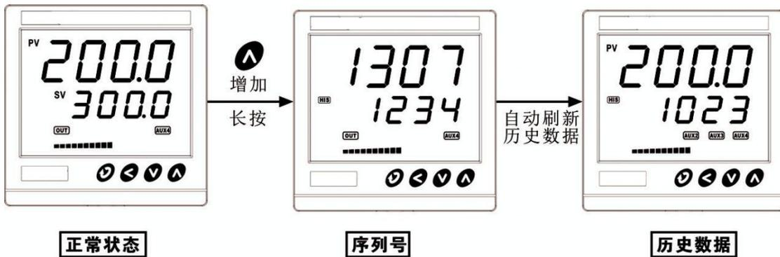
在主界面状态下长按  $\uparrow$ ，进入历史数据浏览界面。先显示刷新出厂编码、测试 CODE，当 int 参数为 0 时，自动退出。当 int 参数非 0 时，随后自动刷新最近的 1024 个点的历史数据，上排数码管显示历史 PV 值，下排数码管显示距当前时刻间隔点个数总共 1024 个点。历史数据依次刷新结束，自动退出此界面，返回主界面。在刷新过程中短按  $\uparrow$  可暂停刷新，长按  $\uparrow$  停止刷新返回主界面。在自动刷新浏览过程中 HIS 状态灯亮，退出浏览后，熄灭。
